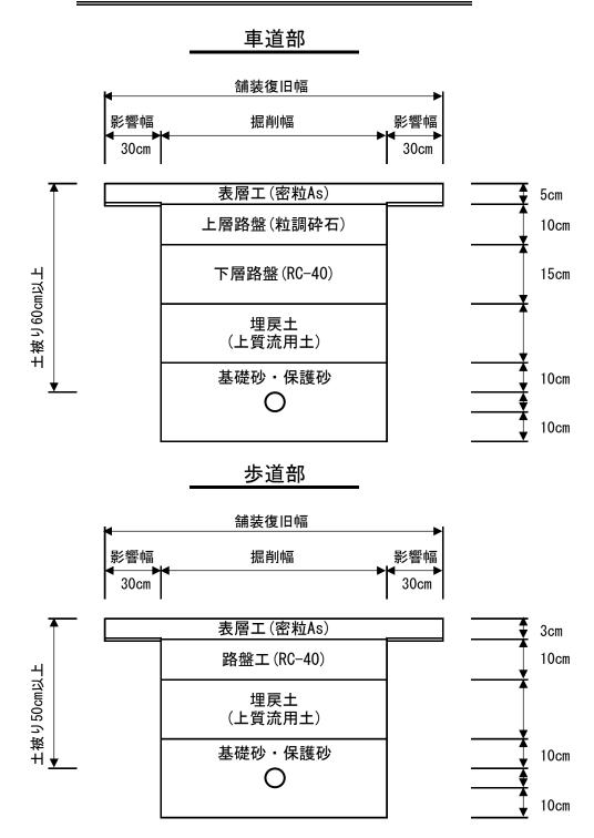
※ 掘削影響部の路盤工(二重線部分)については、不陸整正を行う。
